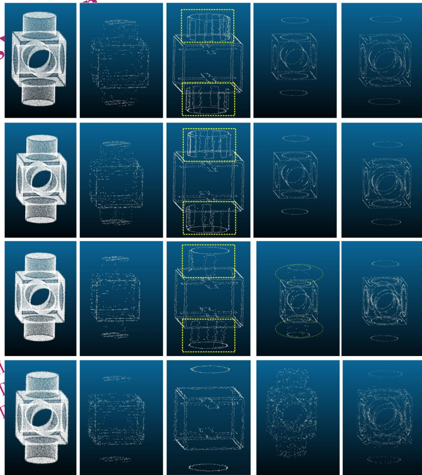
图 11 不同噪声水平下不同方法的轮廓特征点提取
